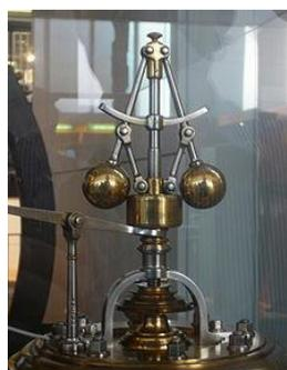
Der ‚Regelkreis‘ war eine der leitenden Vorstellungen der Kybernetik; ihr prominentestes Modell der Fliehkraftregler des 19. Jahrhunderts, der, abhängig von der Drehzahl einer Dampfmaschine, deren Dampfzufuhr steuerte, und damit die Drehzahl immer automatisch konstant hielt. Die Vorstellung einer ‚negativen Rückkopplung‘, die automatisiert – ohne menschlichen Eingriff – für einen Zustand des *Gleichgewichts* sorgt, ging in nahezu alle kybernetischen Überlegungen ein.
