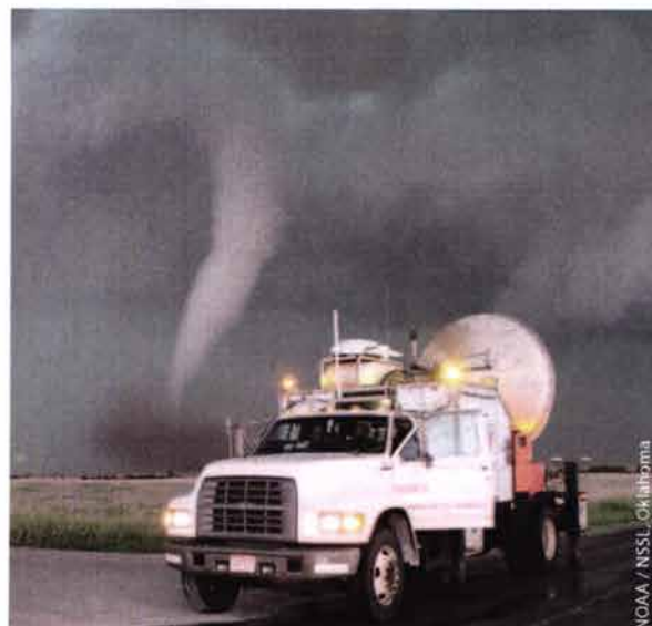
Abb. 6 Tornados lassen sich mittels mobilem Doppler-Radar beobachten. Die Radarantenne ist auf der Rückseite des Fahrzeugs zu erkennen.
